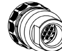
5. Beispiel: Endgehäuse verkleinert, mit Schlüsselfläche versehen
